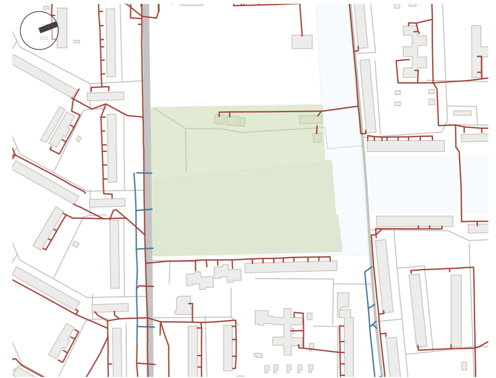
— Коллектор бытовой канализации — Ливневая канализация 60% износа
