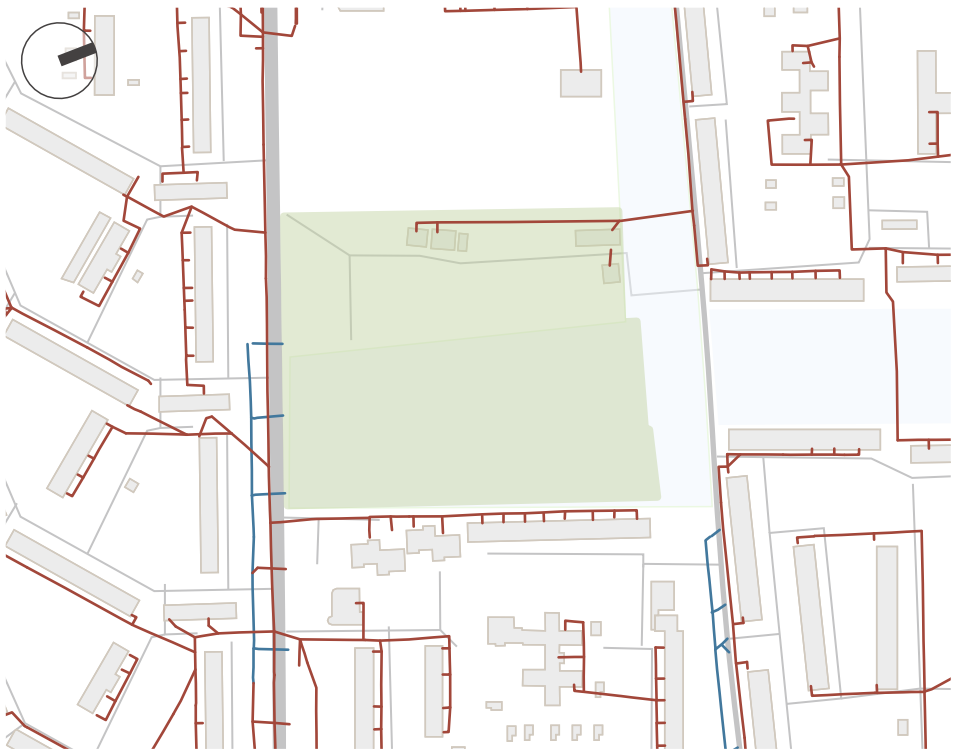
— Коллектор бытовой канализации — Ливневая канализация 60% износа
